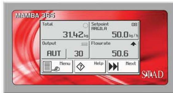
Strumento in custodia (196 x 105 x 70 mm, foratura 187 x 97 mm) per montaggio a fronte quadro. Display LCD 5.2" Touch screen. Grado di protezione del frontale IP 65.
