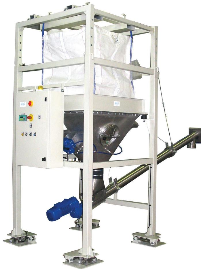
STAZIONE SBB-C PESATA COMPLETA DI COCLEA DI ESTRAZIONE E QUADRO DI COMANDO
