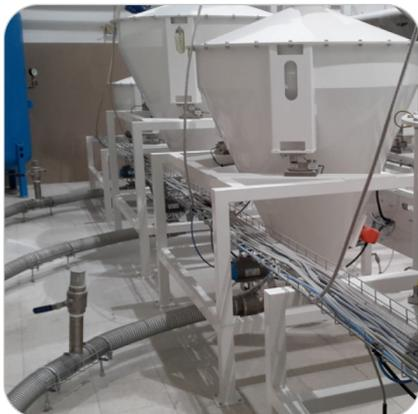
BATTERIA DI TRAMOGGE PESATE DI CARICAMENTO
