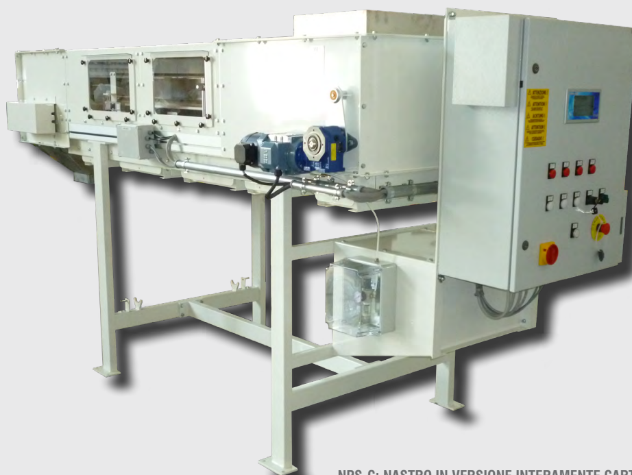
NPS-C: NASTRO IN VERSIONE INTERAMENTE CARTERATA E COMPLETO DI QUADRO ELETTRICO LOCALE CON ELETTRONICA COBRA 365
